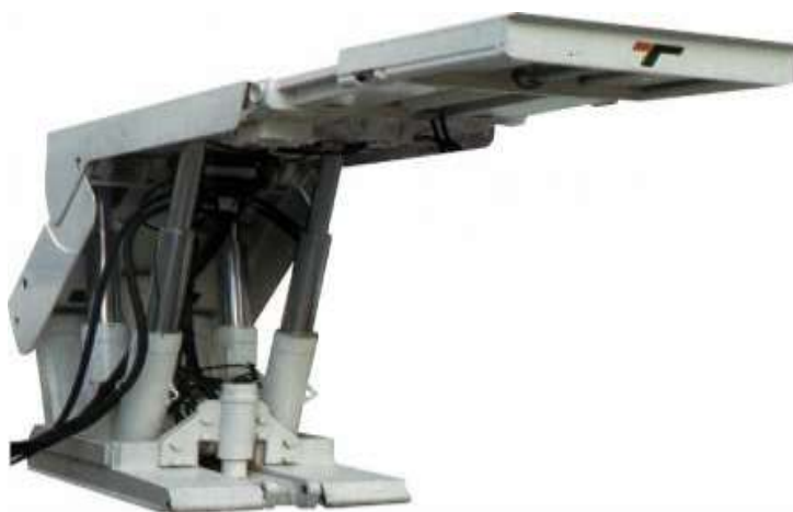
Рисунок 2.3 – Проходка забоя механизированной крепью ЩН-1С.
